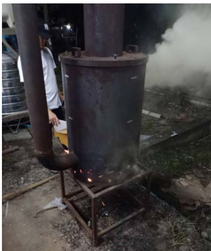
รูปที่ 7 การทดลองเตาเผาถ่านกัมมันต์แบบปิดฝาเตา
