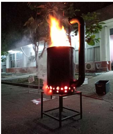
รูปที่ 8 การทดลองเตาเผาถ่านกัมมันต์แบบเปิดฝาเตา
