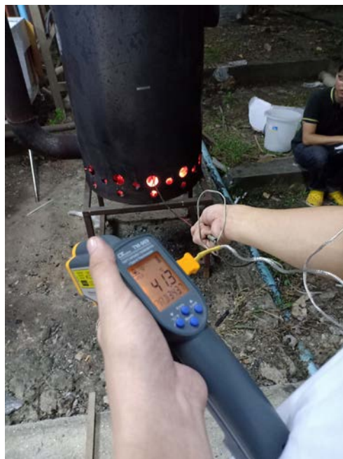
รูปที่ 6 การใช้เทอร์โมมิเตอร์วัดอุณหภูมิแต่ละชั้นของเตา
