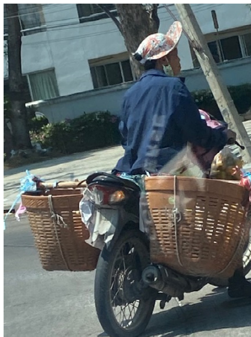
รูปที่ 3 การติดอุปกรณ์เสริมท้ายรถจักรยานยนต์เพื่อเพิ่มพื้นที่การขนส่งสินค้า
