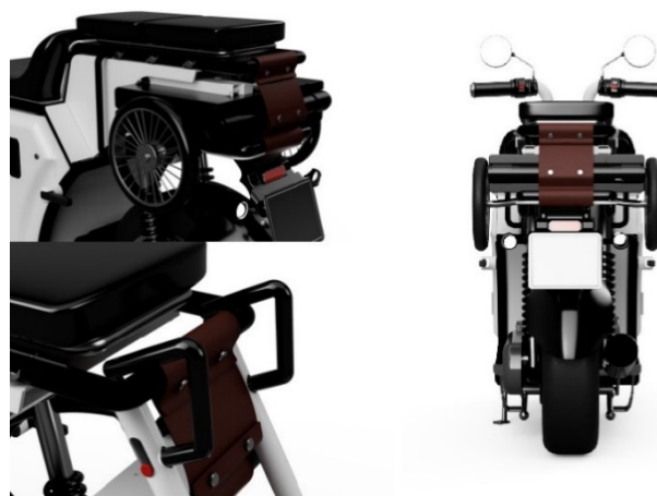
รูปที่ 18 ภาพการติดตั้งและเก็บของอุปกรณ์ฟ่วงกับรถจักรยานยนต์
