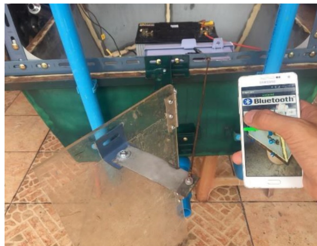
รูปที่ 8 การควบคุมทางเสื่อเรือผ่านสัญญาณบลูทูธ
