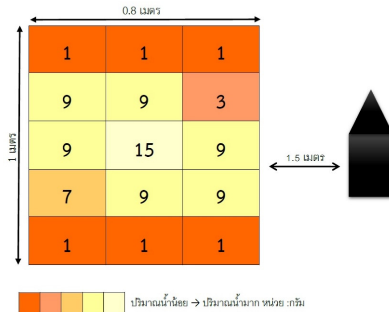
รูปที่ 7 แสดงปริมาณน้ำที่แต่ละตำแหน่งของเครื่องรดน้ำกร่องพลังงานแสงอาทิตย์
