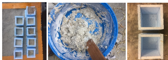
รูปที่ 2 การผลิตก้อนตัวอย่างสำหรับทดสอบ
