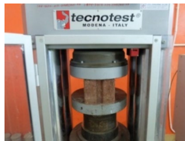
รูปที่ 6 การชักตัวอย่างและการทดสอบความต้านทานแรงอัดของอิฐบล็อกประสาน
