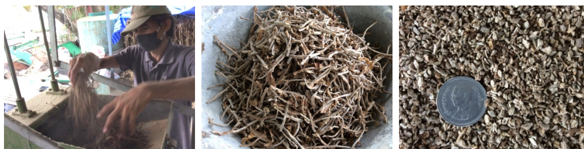
รูปที่ 3 การบดย่อยเศษก้านใบยาสูบผ่านตะแกรงขนาด 4 มิลลิเมตร
