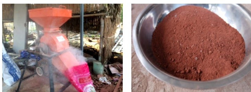
รูปที่ 4 การบดย่อยดินลูกรังผ่านตะแกรงเบอร์ 4
