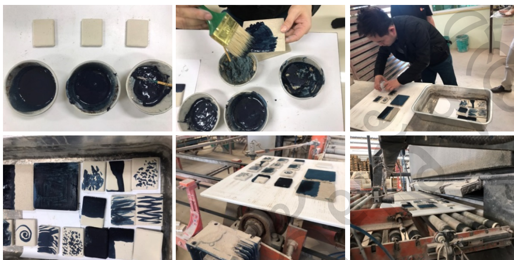
รูปที่ 10 การทดลองย้อมกระเบื้องด้วยการจุ่มและเพ้นท์ลงไปและเผาอุณหภูมิ 1,300 องศาเซลเซียส
