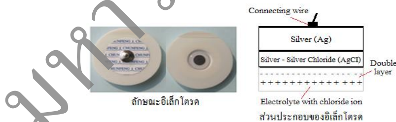
รูปที่ 2 แสดงลักษณะและส่วนประกอบของ Ag-AgCl Pregelled disposable electrode
