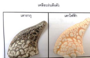
รูปที่ 3 ภาพเปรียบเทียบเคลือบผิวร่นหดตัว ในการเผาเตารากู Reduction และเตาไฟฟ้า Oxidation เเผาอุณหภูมิ 1030 องศาเซลเซียส
