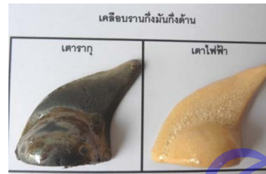
รูปที่ 2 ภาพเปรียบเทียบเคลือบรานกึ่งมันกึ่งด้าน ในการเผาเตารากู Reduction และเตาไฟฟ้า Oxidation เเผาอุณหภูมิ 1030 องศาเซลเซียส
