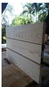
รูปที่ 16 การประกอบไม้สามชั้นโดยการเข้าเดือยไม้
