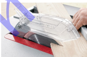
รูปที่ 25 อุปกรณ์ด้านความปลอดภัยพร้อมต่อพ่วงกับเครื่องดูดฝุ่นเพื่อเป็นป้องกันในเรื่องของเศษไม้จากการตัด และเพื่อความปลอดภัยในการปฏิบัติงาน
