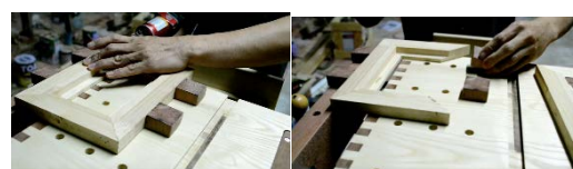
รูปที่ 31 การใช้งานแคลมป์ล็อกและปากกาจับยึดชิ้นงาน
