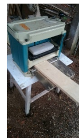
รูปที่ 13 ภาพแสดงการไสไม้ โดยเครื่องไสไม้ เพื่อให้ผิวไม้เรียบเนียน
