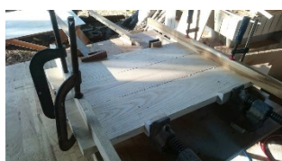
รูปที่ 17 การต่อไม้เข้าด้วยกันด้วยการใช้กาวและใช้เครื่องมือช่วยจับยึด
