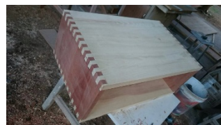
รูปที่ 20 ลักษณะการเข้าเดือยวิธีนี้จะช่วยเพิ่มความแข็งแรงในการรับน้ำหนักของเวิร์กสเตชัน
