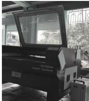
รูปที่ 6 เครื่องเลเซอร์กัด LTL E14090
