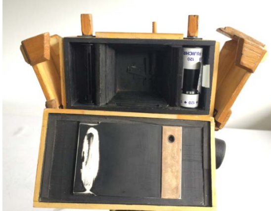
รูปที่ 3 แสดงภาพกล้องรูเข็มขณะใส่ฟิล์ม
