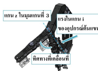
รูปที่ 14 จัดท่าแขนกลทุกแกนให้ทำมุมในลักษณะ 0°
