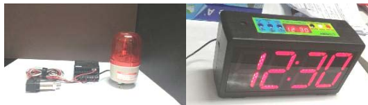
รูปที่ 11 ชุดควบคุมความปลอดภัยเครื่องอัดฟลิตฟ้าจริง ได้แก่ อุณหภูมิ ความดันไอน้ำ และระยะเวลาการอบไอน้ำ
