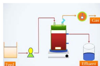
รูปที่ 1 ระบบหมักแก๊สชีวภาพด้วยถังปฏิกรณ์แบบกวนต่อเนื่อง (Continuous Stirred Tank Reactor, CSTR)
