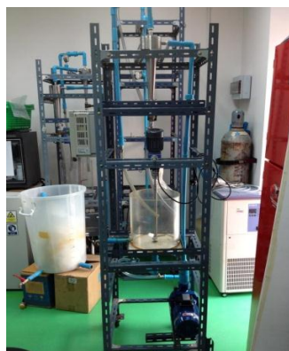
รูปที่ 1 ชุดทดลองของไฮโดรไซโคลน
