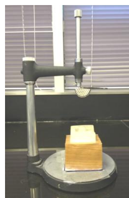
รูปที่ 1 แสดงเครื่องมือกดถาดพิมพ์ปากลงบนโมเดลต้นแบบ
