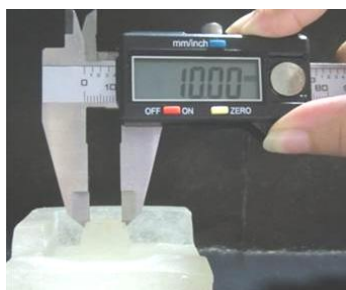
รูปที่ 3 แสดงการวัดความกว้างและความยาวด้วยเวอร์เนียคาลิเปอร์
