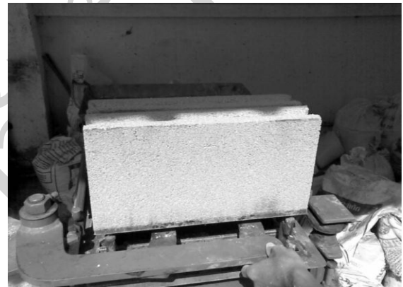
รูปที่ 7 คอนกรีตบล็อกจากกากดินขาว
