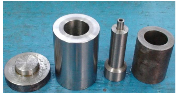
รูปที่ 3 อุปกรณ์ขึ้นรูปอ้างอิงจากชิ้นงานมาตรฐานรูปทรงกระบอกขนาด 51x51 มิลลิเมตร ตามมาตรฐาน ASTM Designation: C 20-97 (American Society of Testing and Material, 2000)
