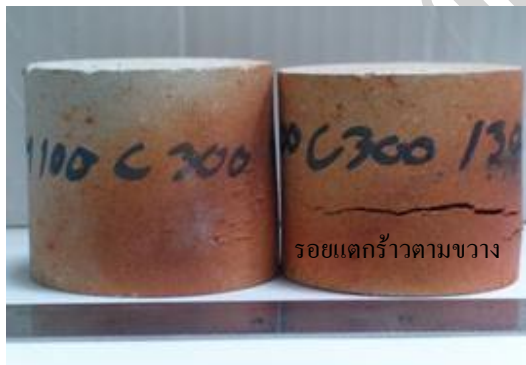
รูปที่ 5 ชิ้นงาน B3 เกิดการเสียรูปและแตกร้าว
