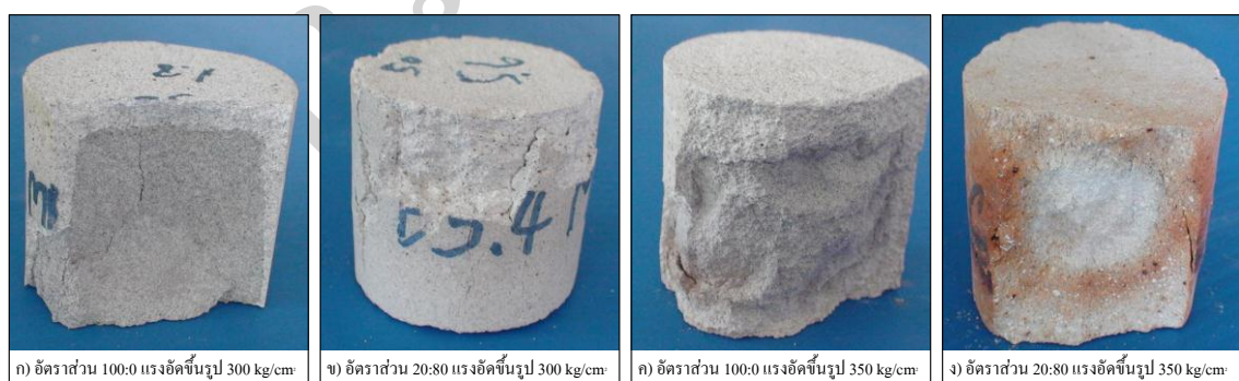
รูปที่ 7 การพังทลายของชิ้นทดสอบการบีบอัด
