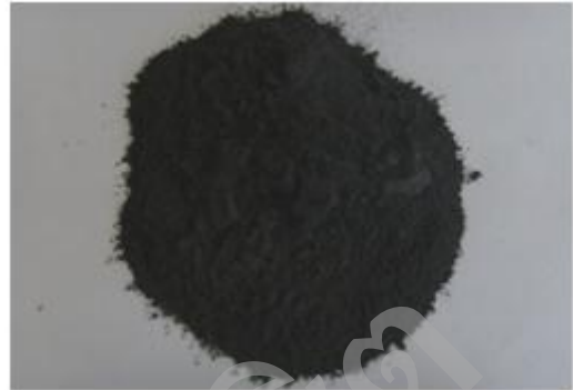
รูปที่ 1 ซีตะแกรงอลูมิเนียม ขนาด 200 เมช สำหรับใช้ผสมในพอลิพรอพิลีน
